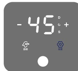
上图显示为设置冲洗阀打开时间状态,按“设置”切换显示“S”状态下,设置冲洗阀打开的时间分别是15秒/30秒/45秒/60秒/90秒,按“+”和“-”按键设置需要的冲洗阀打开时间。
