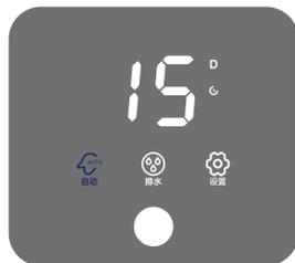
上图显示为出厂默认状态(同重启后状态)“自动”状态下,控制器会在间隔15天后,自动打开冲洗阀排水15秒,再自动关闭冲洗阀,以此循环。间隔过程中,按唤醒按键,可以显示倒计时还有多少天后自动打开冲洗阀,此唤醒状态下可以按“排水”按键,手动打开冲洗阀,手动开关冲洗阀后会重新开始15天计时。
