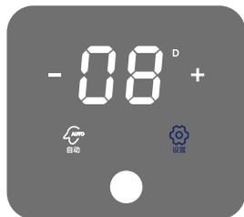
上图显示为设置冲洗阀冲洗周期,按“设置”切换显示“D”状态下,设置冲洗阀每隔0.5天后开冲洗阀一次,以此循环。按“+”“-”按键设置需要的天数。
