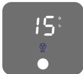
左图显示为手动开关状态,冲洗阀打开阶段倒计时数字如“15”为闪动,打开到位后数字开始倒计时,倒计时结束后显示“00”闪动表示冲洗阀在关闭状态,冲洗阀打开和关闭过程中“排水”按键灯始终闪动。
